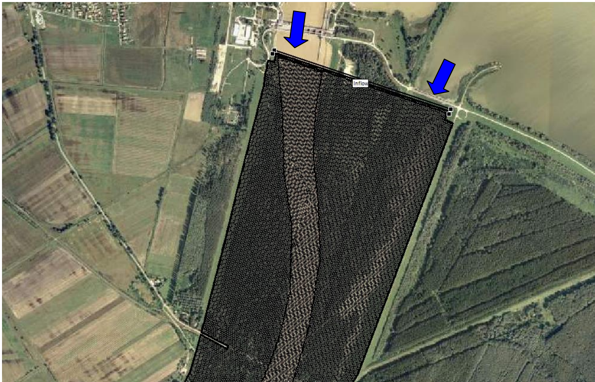
40. ábra 2D modell felső határfeltétele
